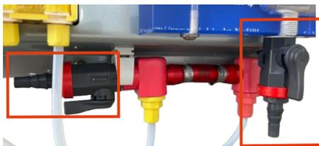
**Beide Kugelhähne** in Flussrichtung öffnen und eine Dichtheitsprüfung durchführen. (Die Filterpumpe muss aktiv sein.)
